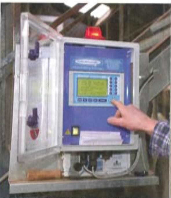
De activiteit van koeien met een Heatime transponder wordt via een antenne naar de besturingskast gestuurd. De bijgeleverde software bepaalt of een koe tochtig is of te weinig actief is. In beide gevallen gaat het rode licht knipperen.
